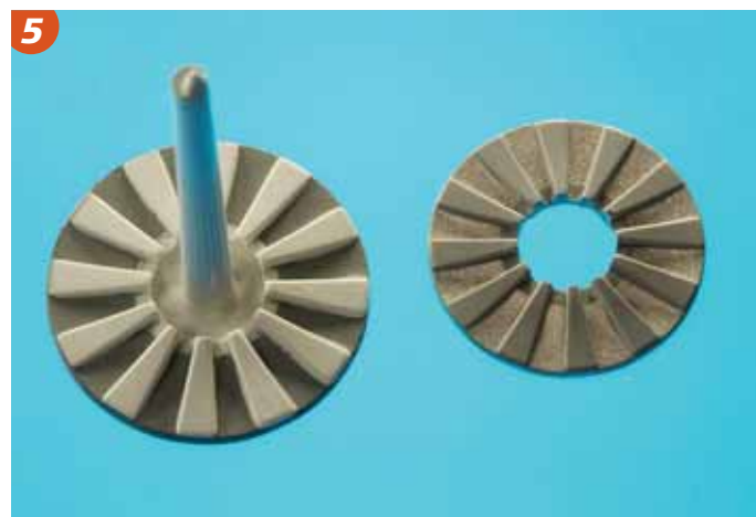
Bild 5 • Folienhinterspritzen von Stahl- ZrO_2 -Verbunden (BMW-Projekt „GreenTaPIM“, FKZ 16IN0319)
