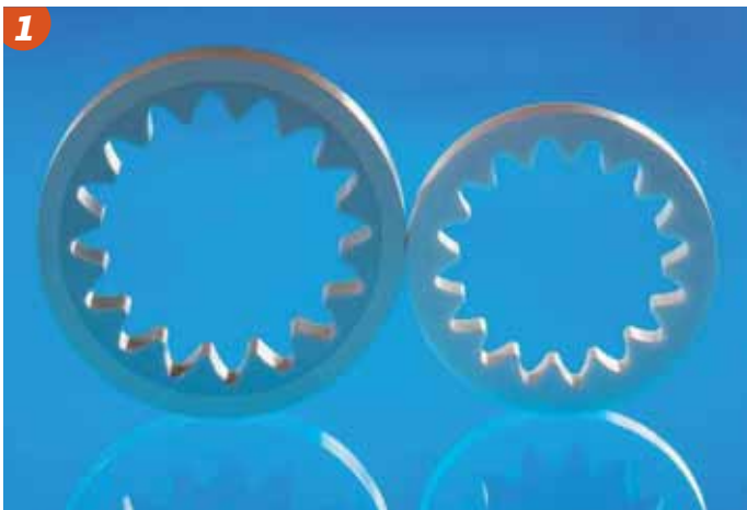
Bild 1 • Spritzgegossener Werkstoffverbund \text{Al}_2\text{O}_3/\text{ZTA} (EU-STREP-Projekt „CarCIM“, FKZ TST 5-CT-2006-031462)
