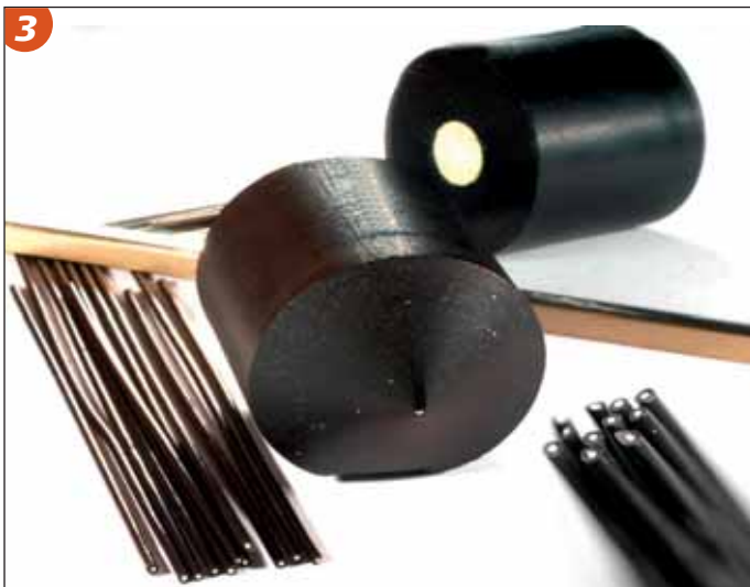
Bild 3 • Modular aufgebaute Vorformen und deren coextrudierte PZT-Monofilament-Komposite
