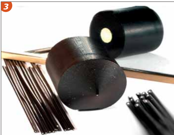
Bild 3 • Modular aufgebaute Vorformen und deren coextrudierte PZT-Monofilament-Komposite
